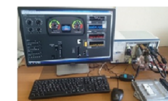
ПАК эмуляции работы ЭБУ и газового ДВС.
