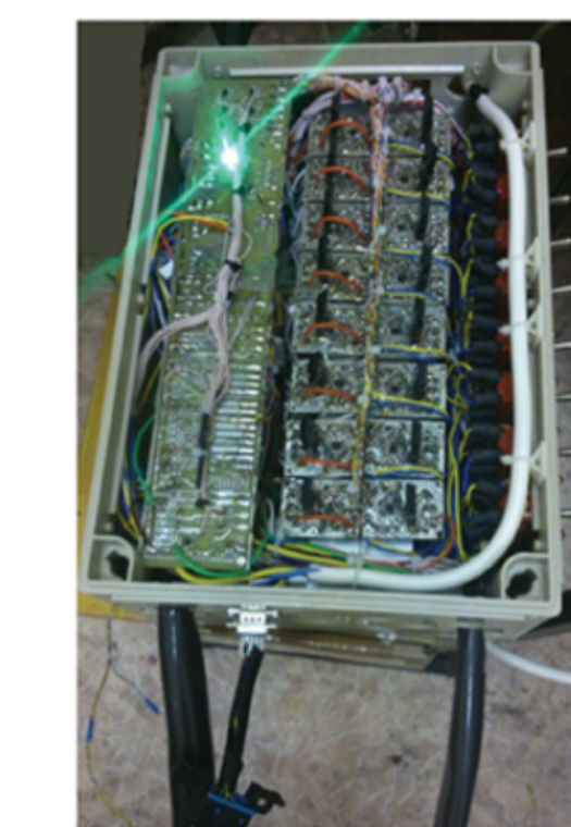
Корпус с смонтированными в нем эмулирующими платами
